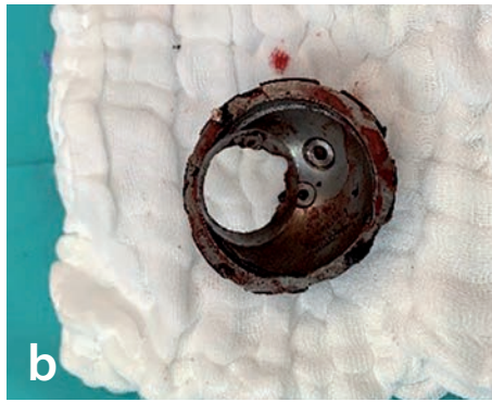
Abb. 2: Materialschaden am Keramikkopf (a), Metallträger (b) und zerbrochenes PE-Inlay (c)
