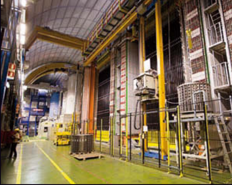
Der haushohe, aus tausenden von Bleiziegeln aufgebaute Neutrinodetektor unter dem Zentralmassiv des Gran Sasso.
