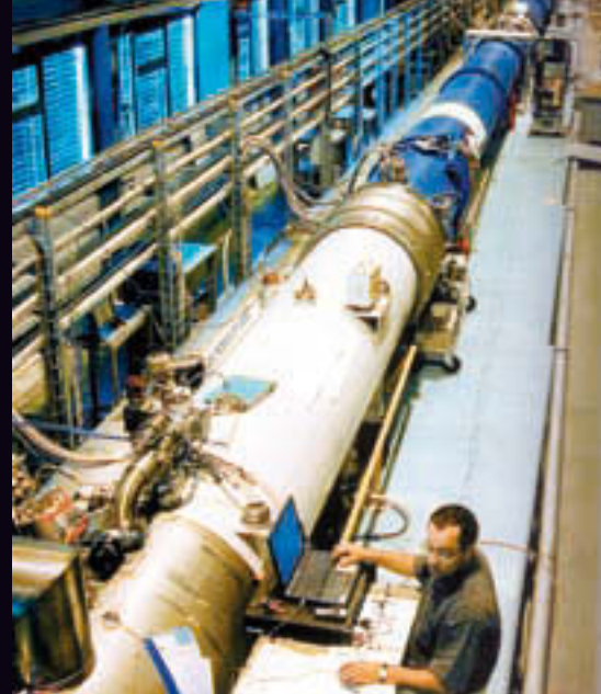
Teilansicht des kilometerlangen Protonenbeschleunigers, der am CERN den Neutrinostrahl erzeugt
